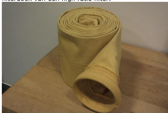
Afbeelding 2. Filterslang van een doekenfilter.
