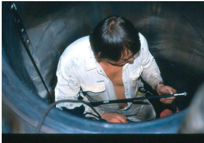
Afbeelding 17. Het opmeten van de cilindervoering met behulp van een speermaat.
