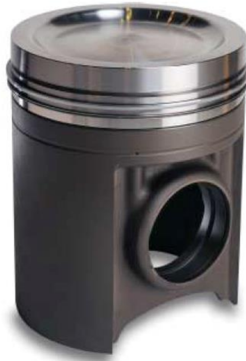
Afbeelding 18. Zuiger met veren, de kroon is van gietstaal, het hemd van nodulair gietijzer.
