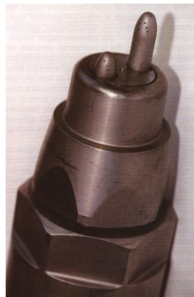
Afbeelding 10. Verstuivernozzle met aparte waterinjectie.
