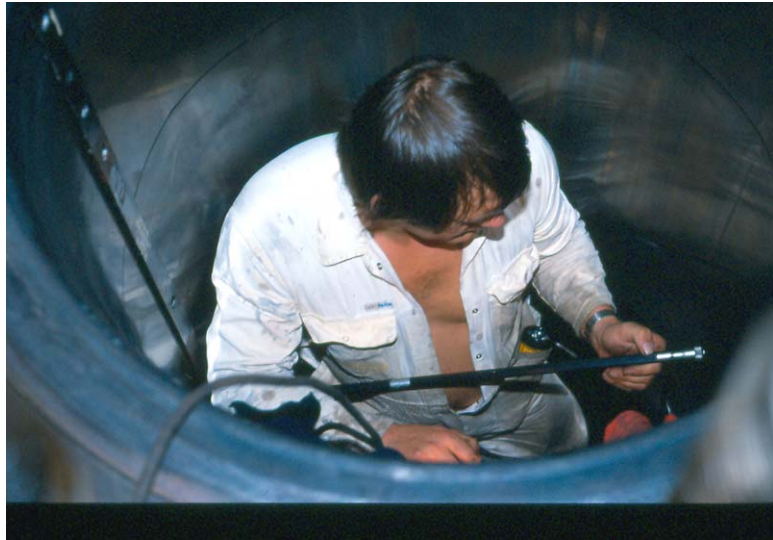
Afbeelding 16. Het opmeten van de cilindervoering met behulp van een speermaat.
