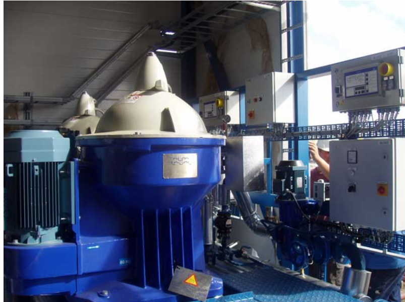
Afbeelding 1. Foto van een moderne zware olie centrifuge. Bron WEB Aruba.
