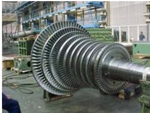
Afbeelding 31. Foto van een Parsonsrotor met voorgeschakeld Zoellywiel.
